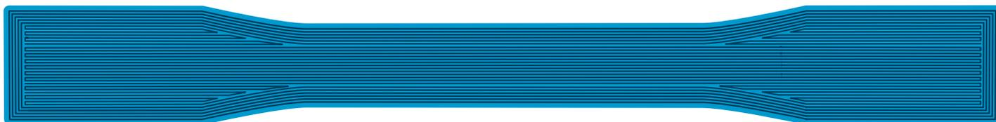
Figura 6 - Provino di trazione D638 con percorsi utensile unidirezionali in posizione nella zona utile centrale.
