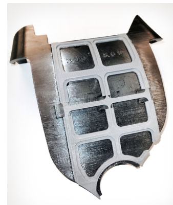
Dispositif de positionnement d'emblème imprimé en 3D avec un cadre renforcé de fibre de carbone (gris) et un revêtement en TPU.
